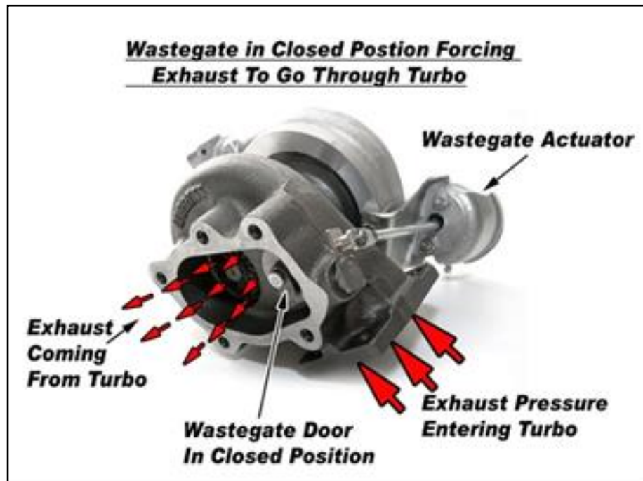
RAJAH 14 : WASTEGATE ACTUATOR
