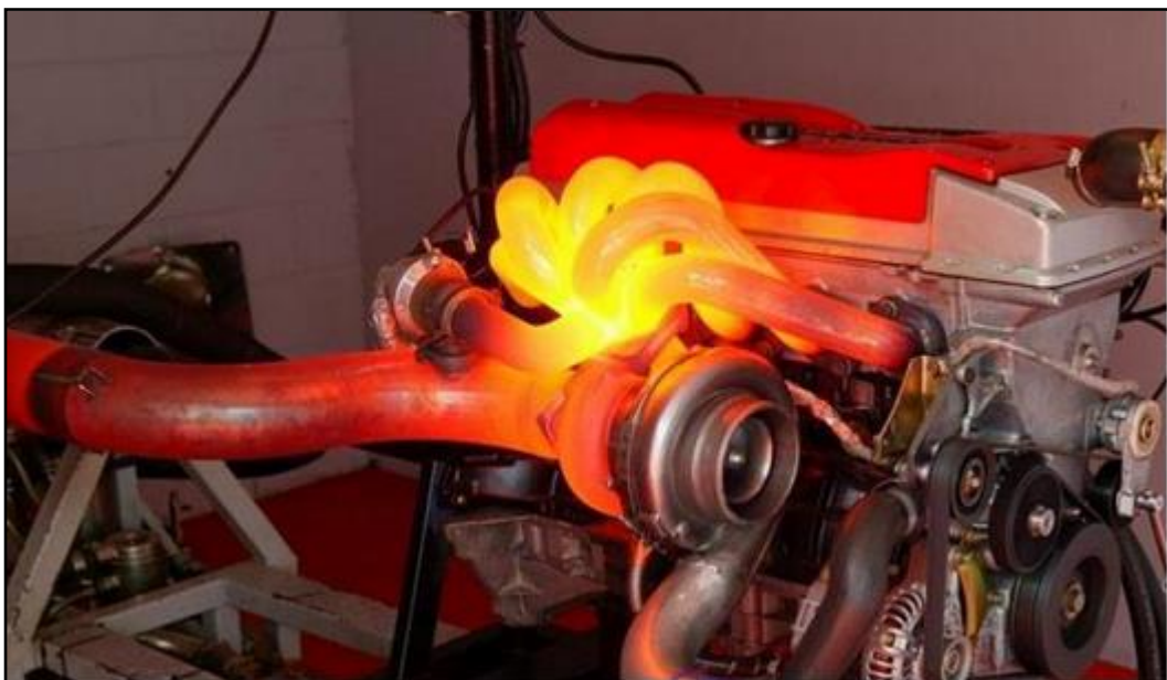
RAJAH 7 : CONTOH SUHU TURBOCHARGER TERLAMPAU PANAS
