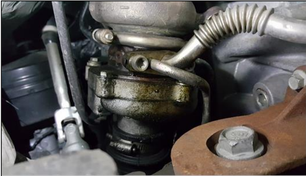
RAJAH 2 : CONTOH OIL LEAK PADA TURBOCHARGER
