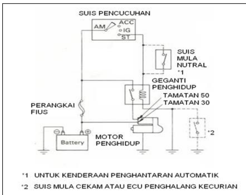
RAJAH 22 : LITAR PENGHIDUP DENGAN GEGANTI PENGHIDUP
